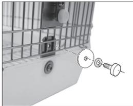
プラスチック底と本体アミとを固定している両側のネジ類をはずします。
